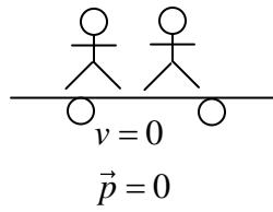
$$\begin{aligned}0 &= m' \vec{v}' + m \vec{v} \\0 &= 400kg \vec{v}' + 100kg(5.0\%_s + \vec{v}') \\0 &= 400\vec{v}' + 500 + 100\vec{v}' \\0 &= 500 + 500\vec{v}'\end{aligned}$$
