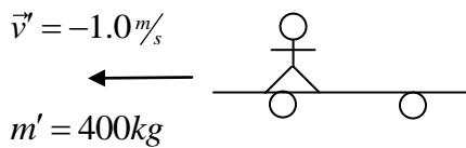
$$\begin{aligned}m' \vec{v}' &= m'' \vec{v}'' + m \vec{v} \\400kg(-1.0\%) &= 300kg \vec{v}'' + 100kg(-5.0\%_s + \vec{v}'') \\-400 &= 300\vec{v}'' - 500 + 100\vec{v}'' \\100 &= 400\vec{v}'' \\ \vec{v}'' &= +0.25\%_s \\ \boxed{\vec{v}'' = 0.25\%_s [N]}\end{aligned}$$
